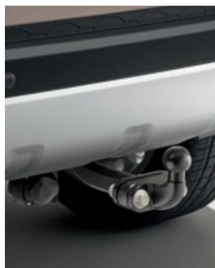
**Нерегулируемое по высоте буксировочное приспособление<sup>††</sup>**
