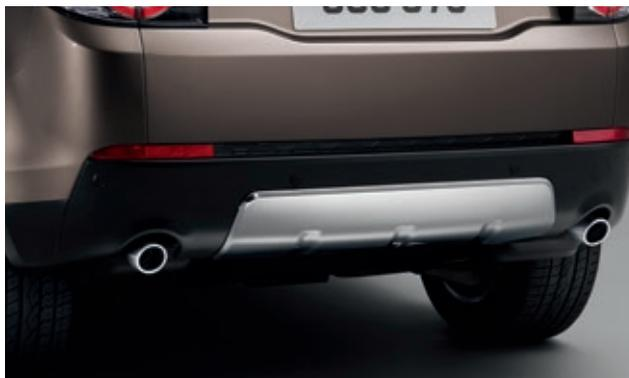
**Задняя нижняя защита кузова из нержавеющей стали\*\***
